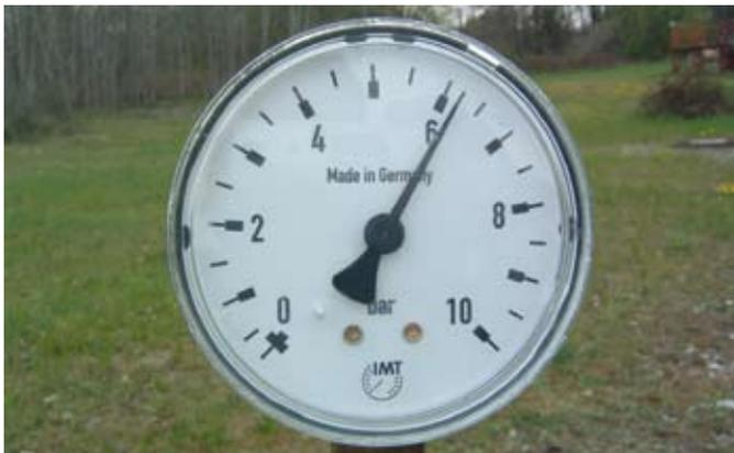
Fig.61: Prova di pressione a 6 bar.
