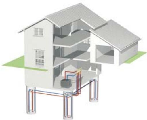
Fig. 3: Pilastro energetico
