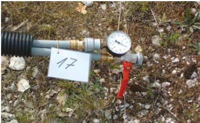
Fig.60: Applicazione dell'unità di controllo nella pressione.
